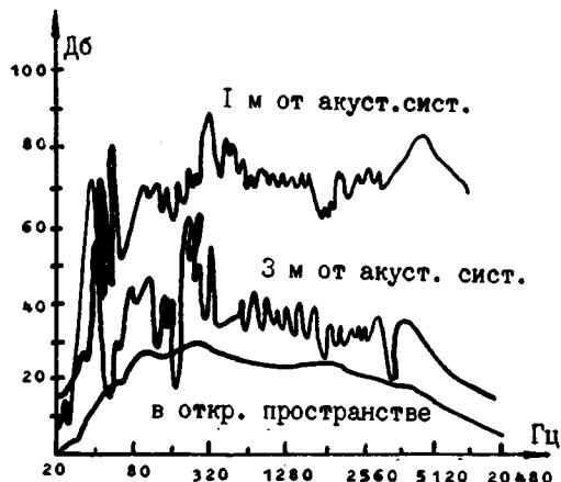
на имеет структуру стоячих волн с явно выраженным пучностями и узлами. Резонансные частоты определяются размерами комнаты [2]. Амплитуда звукового давления в пучностях стоячей волны на 10-25 дБ повышает амплитуду в узле. На рисунке изображена частотная характеристика звукового поля в реальной жилой комнате и в открытом пространстве. Как вид-
